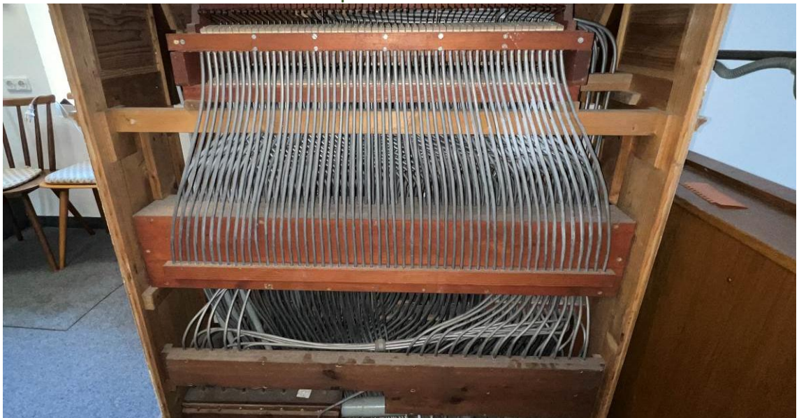
Abbildung 19 Die Verrohrung der Spieltischpneumatik
