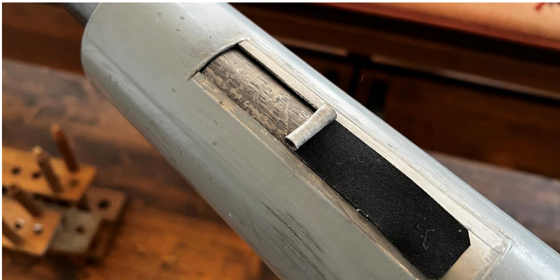
Abbildung 6 Angebrachte Gummitucheinlagen zur Resonanzentfernung an einigen Zinkpfeifen
