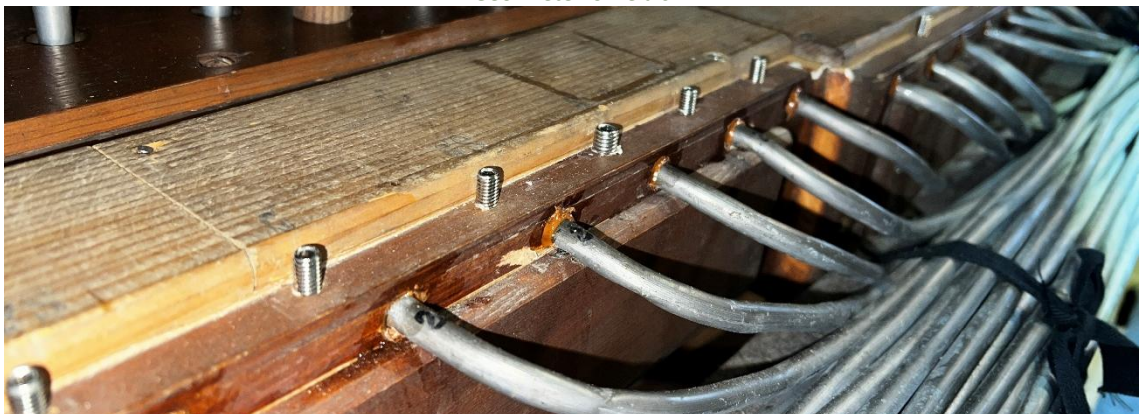
Abbildung 16 Tonrelais mit den neuen Madenschrauben n.d.R.
