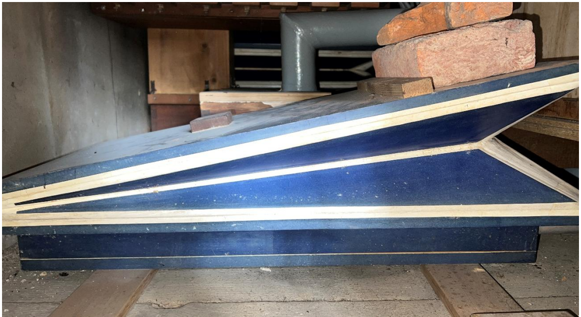
Abbildung 24 Keilbalg der Windabschwächung im Subbass 16'
