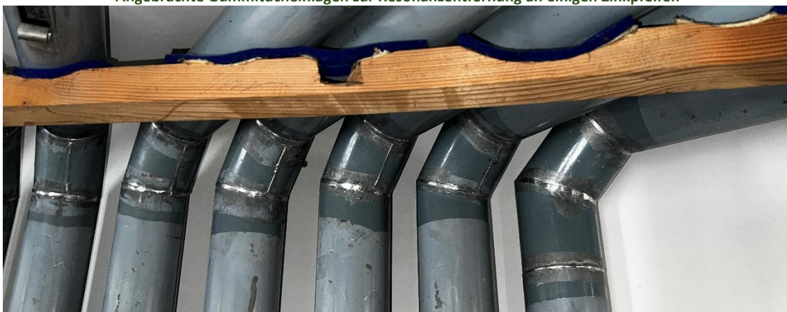
Abbildung 7 Neu gelötete Pfeifenkröpfe im Salicional 8'
