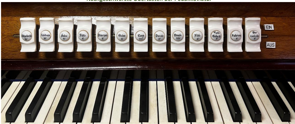
Abbildung 22 Neu eingebaute Registerstaffel mit historischen Porzellanplättchen
